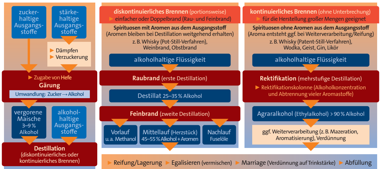
Herstellung von Spirituosen durch alkoholische Gärung und Destillation (diskontinuierliches oder kontinuierliches Brennen)
